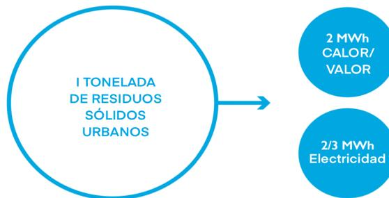
Salida típica de energía de la instalación de cogeneración con entrada de MSW a 10 MJ/kg (2,8 MWh/tonelada) de valor calórico neto. La generación de calor de la condensación de los gases de combustión no está incluida. El vapor puede transformarse en calor con una pérdida insignificante. Sin salida de vapor, la producción de electricidad aumentaría
